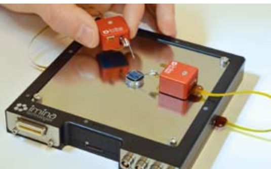
▲ „miBot BT-11“: Mit dem Gerät lassen sich Oberflächen bei einer Auflösung bis 60 Nanometer, also 60 Milliardstel Meter, untersuchen.
