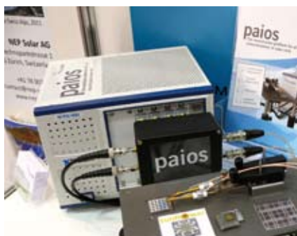
▲ Dynamische Messung einer Solarzelle: Fluxim-Messgerät „Paios“.
